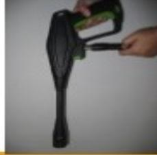
Introduzca la manguera de alta presión directamente en el mango de la pistola y asegúrese de que esté conectada firmemente.
